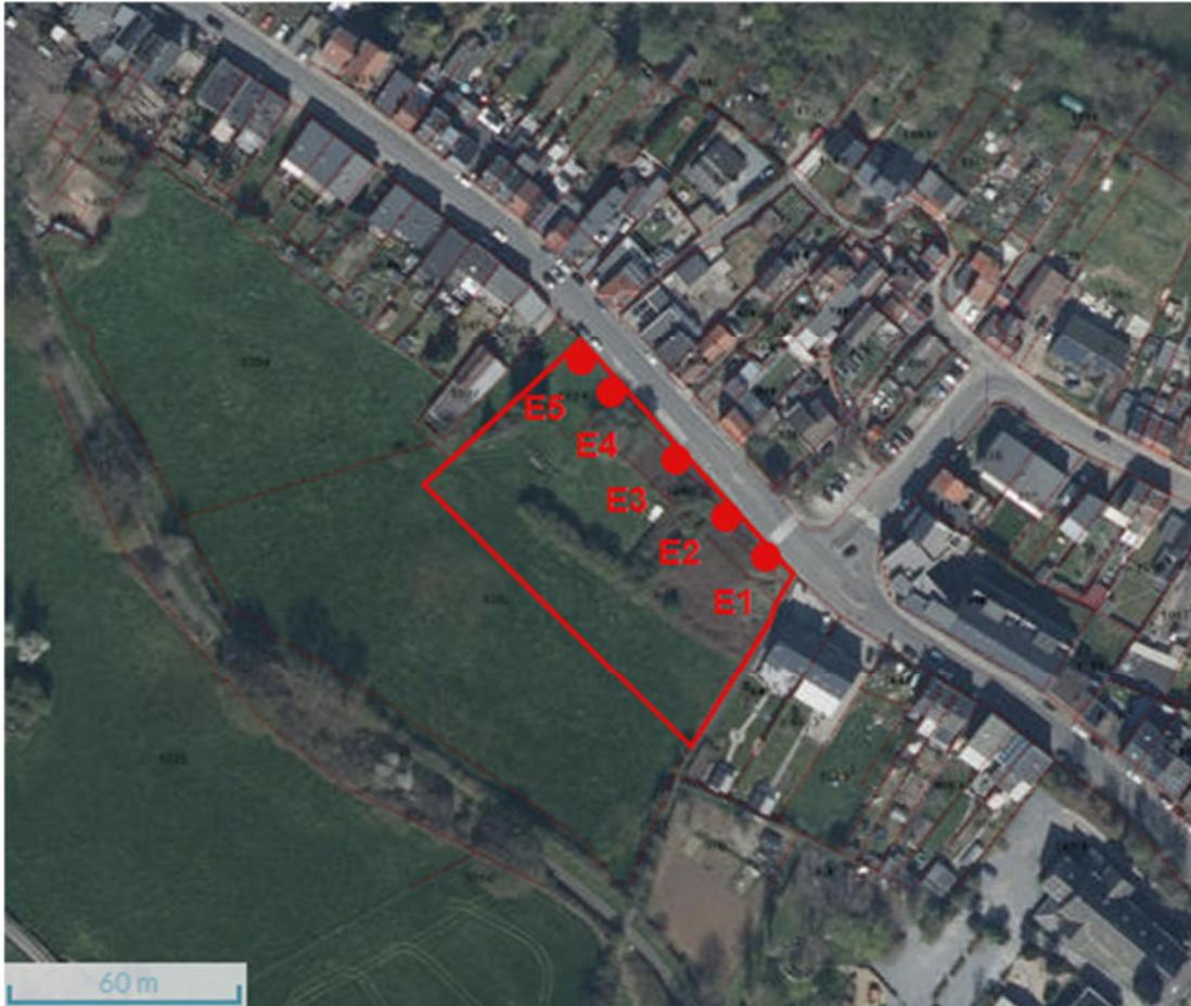
Figure 1 : localisation des tests de perméabilité (source : WalOnMap)
